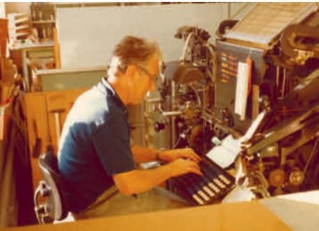
*Setzen mit der Linotype-Maschine: Dieses Verfahren wurde ab 1970 vom Fotosatz abgelöst*
